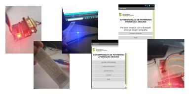
No presente projeto, foi utilizada como metodologia, a linguagem de programação própria para Arduino, blocos lógicos para criação do aplicativo no site MIT app inventor, e para conseguir a comunicação entre a antena e o Arduino, foi necessário um módulo conversor RS485 para TTL.
