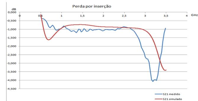
A estrutura planar apresentou um desempenho adequado apesar da sua simplicidade. Com uma perda por inserção menor que 0,5 dB com uma largura de banda que depende somente do material do substrato. Importante se notar que, a partir de meio comprimento de onda na estrutura, a propagação é praticamente TEM. As estruturas balanceadas de fitas paralelas mostram-se então adequadas como sondas para espectroscopia dielétrica.
