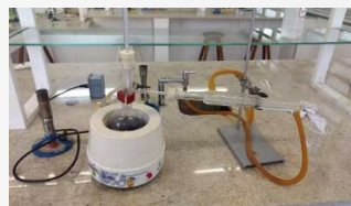
Figura 2. Aumento da pureza dos reagentes por meio de destilação simples
