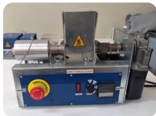
Figura 1: extrusora utilizada para o processo de gelatinizar
