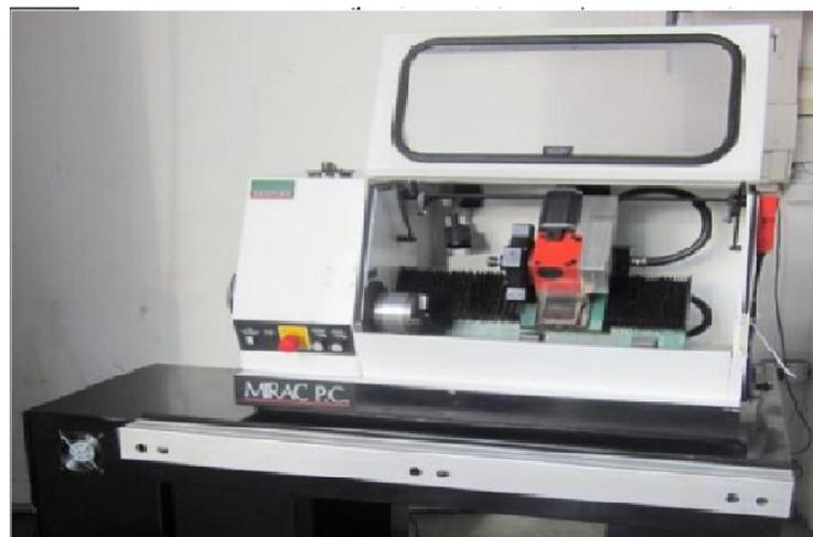
Os módulos executam os comandos e confirmam sua execução para a Raspberry PI que inicia o parser de um novo comando G-Code repetindo esse processo até a usinagem completa da peça.
